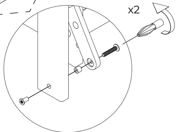
**-No apretar del todo hasta el final del montaje.
