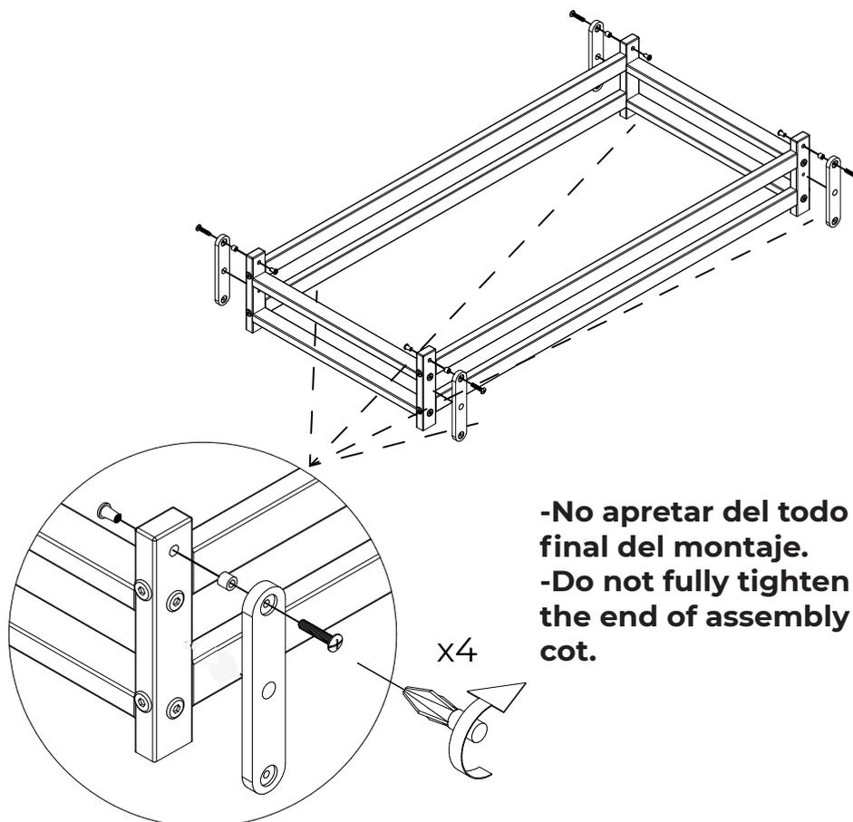
**-No apretar del todo hasta el final del montaje.**
